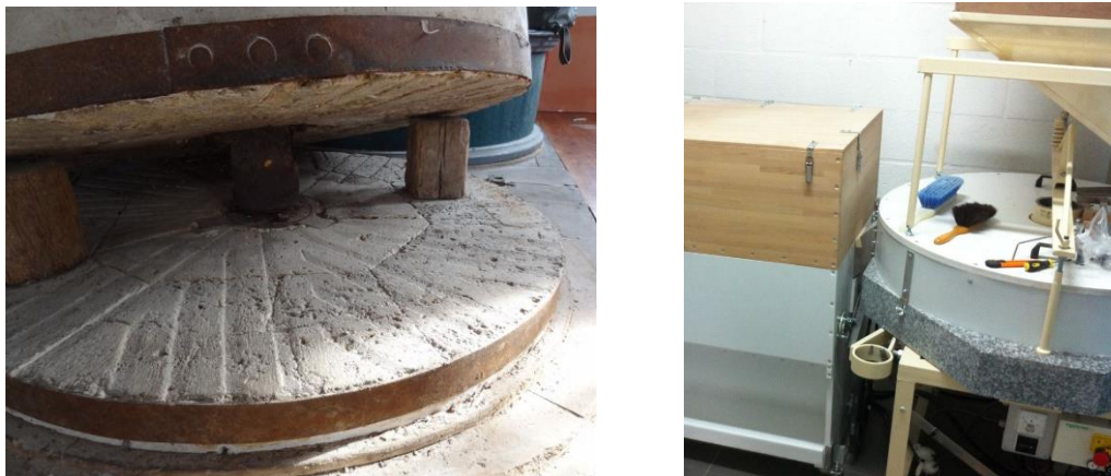
Figure 3. A gauche, meules en pierre d'un moulin de 1850. A droite, moulin à meules pierre moderne.
